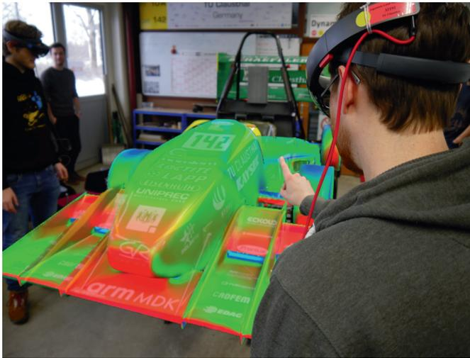
Abbildung 3: Darstellung des Drucks an unterschiedlichen Fahrzeugteilen des GVR-Racers mit der HoloLens. © HCIS
